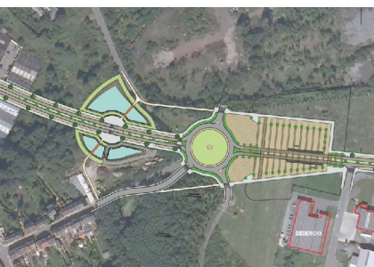
Boulevard urbain : bassin d'orage et place « LD ». Source : SPW.
