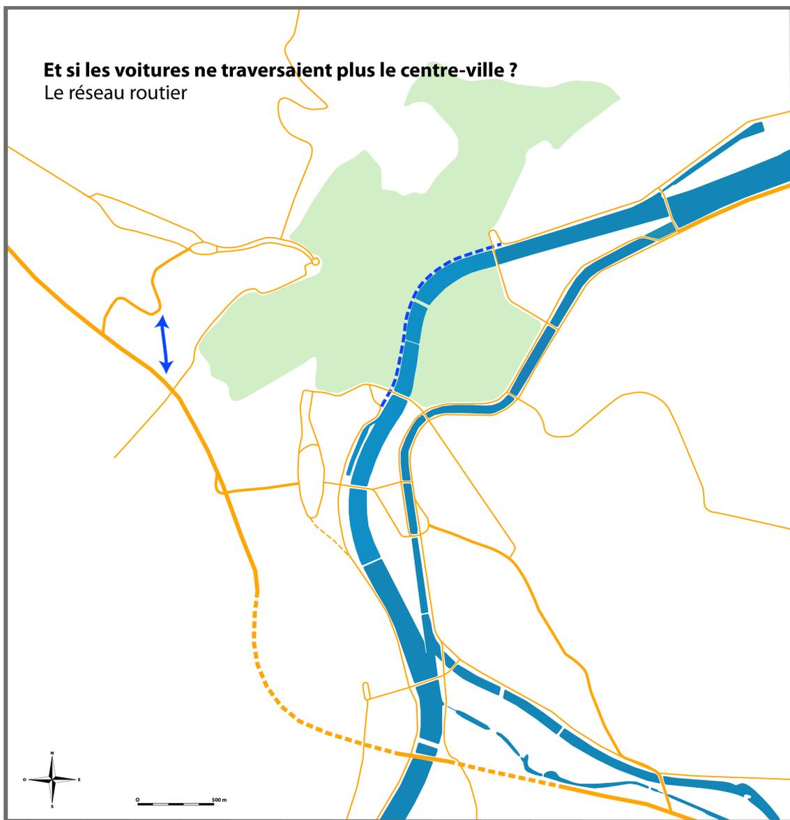
Figure 7 : Situation du tunnel sous les quais (pointillés bleus) et amélioration de la jonction entre l'A602 et Fontainebleau.
