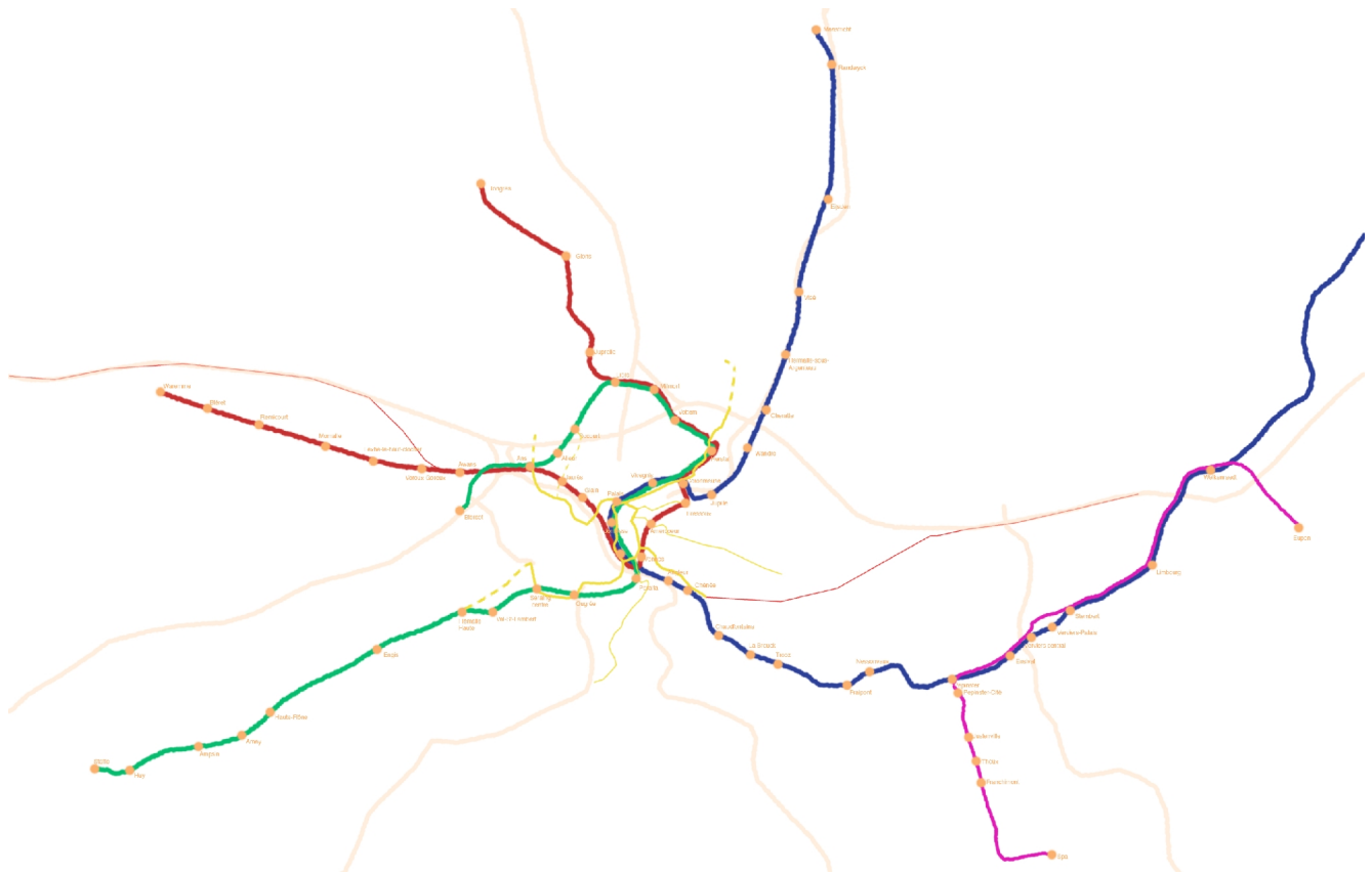
Figure 2: Esquisse d'un réseau de train léger de trois lignes dans la région liégeoise (plus une ligne de tram-train entre Spa et Eupen).
